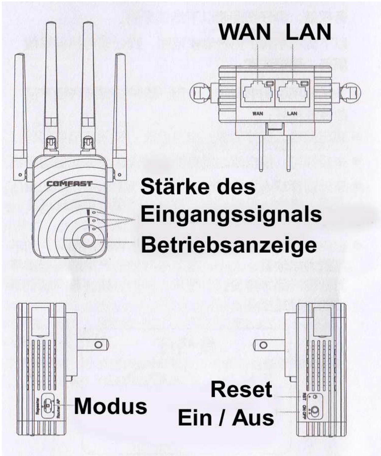
Bitte stecken Sie das Gerät dort, wo Sie ein WLAN-Signal verstärken wollen, in eine Steckdose. Schalten Sie das Gerät ein. Der Modus muss auf „Repeater“ stehen, damit das Gerät als WLAN-Verstärker arbeitet. Dieser Modus ist bereits voreingestellt.
