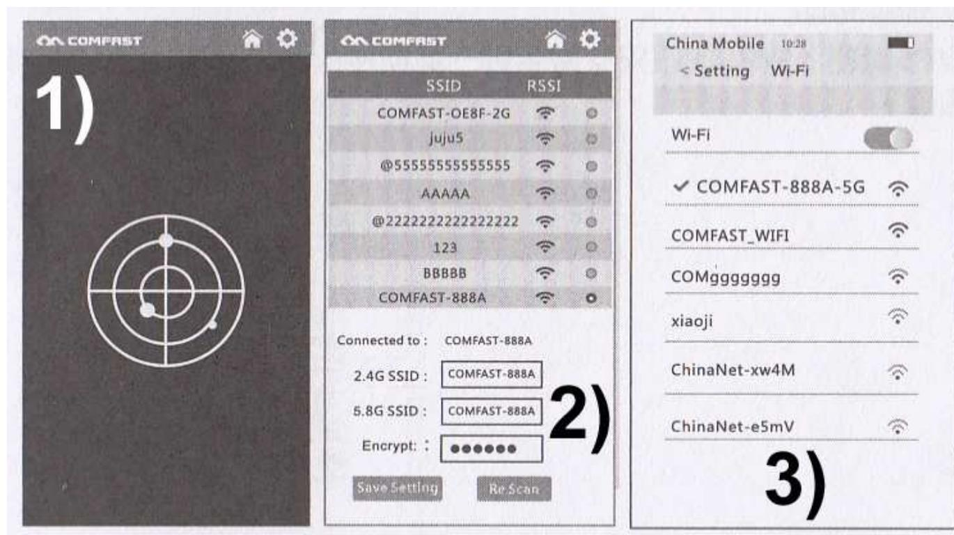
Geben Sie dem Gerät bitte einige Minuten Zeit, um WLAN-Netzwerke in der Umgebung zu finden. Danach sollte das Gerät eine Liste dieser Netzwerke anzeigen und eine Darstellung wie Abbildung 2) erscheinen. Wählen Sie dort in der Liste das Netzwerk aus, das Sie verstärken wollen, und geben Sie dessen Netzwerkpasswort ein. Klicken Sie bitte sodann unten links auf „Save Setting“.
